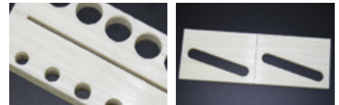
▲ Flexible Bohrungen und Zuschnitte werden durch die Wasserstrahlschneidanlage ermöglicht.
