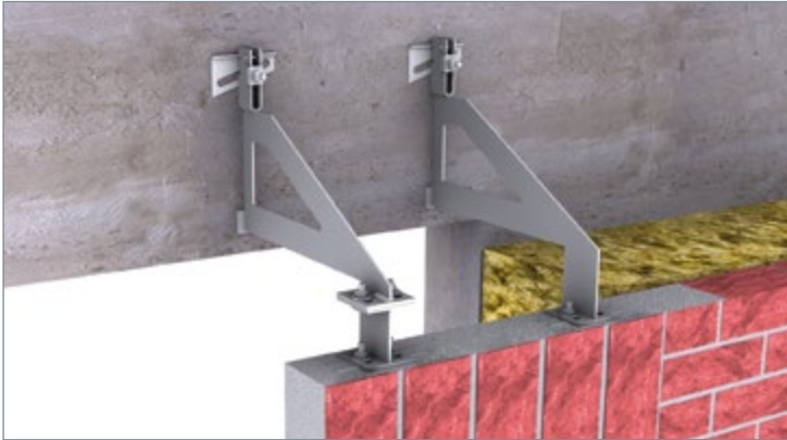
▲ Lagerkonsole FB-U mit FB-V oder Produktions FB-UV Konsole
