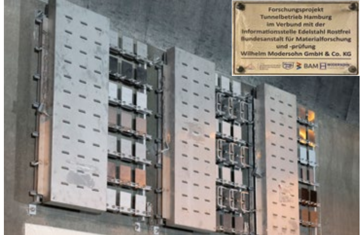
▲ Montage der Werkstoffproben im Elbtunnel Hamburg, im Rahmen eines Forschungsprojektes zur Erweiterung des Anwendungsbereiches des Werkstoffes 1.4462.
