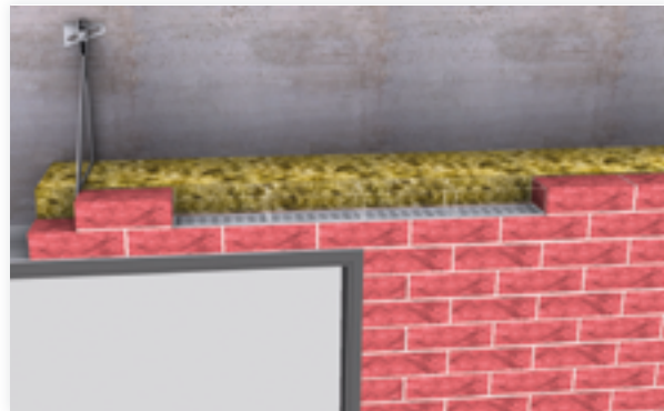
▲ Vorschlag für Situation B: Lochbandlagen in der Lagerfuge des Übergangs Fenster in Pfeiler
