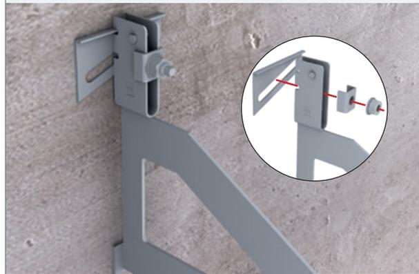
**3** ... Traganker durch Umsetzen der gekröpften Keilscheibe in der Höhe grob und durch Verschieben der Keilscheibe fein justieren...
