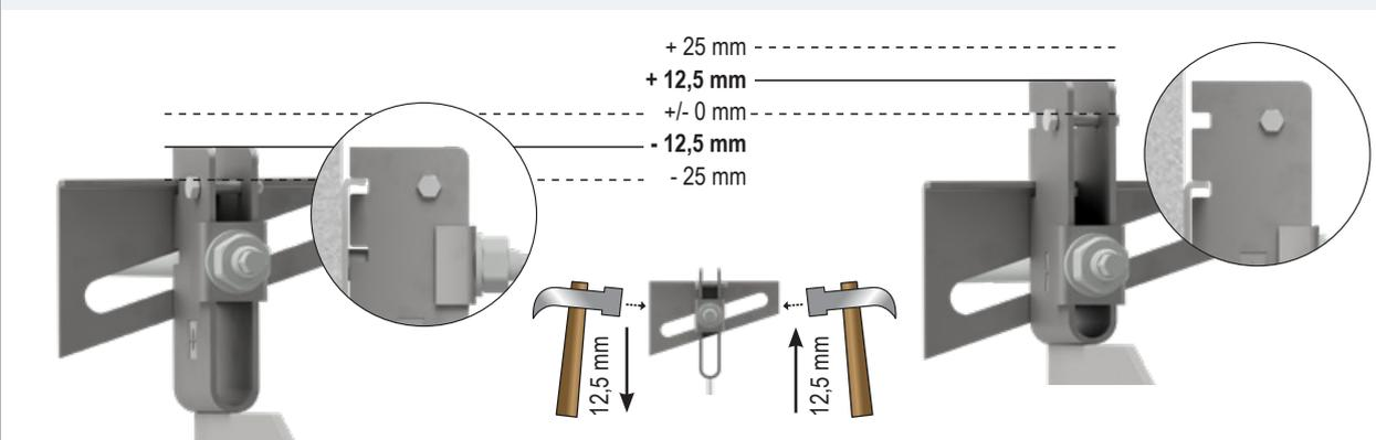
**4** ... die Hammerkopfschrauben MHK mit ihrem Kopf parallel zur Ankerschiene (a) einführen. Die MHK Schrauben im Uhrzeigersinn drehen, bis die Kerbe am Schraubenende parallel zum Langloch der Aufnahmeplatte (b) steht. Aufnahmeplatte der Konsole, U-Scheiben und Sechskantmuttern auf MHK Schraube aufsetzen und handfest anziehen. Fertigteil vom Schalenabstand ausrichten. Hammerkopfschraube mittels Anzugsdrehmoment anziehen...
