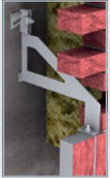
**1** Dübel nach Zulassung setzen. Keilscheibe und Traganker auf die Dübelankerstange aufsetzen...
