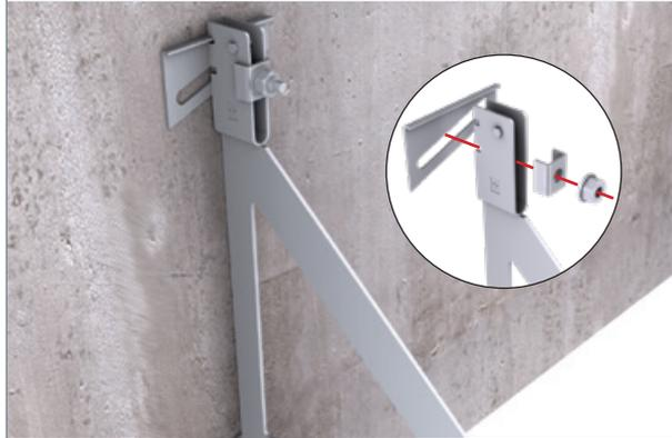
**3** ... Traganker durch Umsetzen der gekröpften Keilscheibe in der Höhe grob und durch Verschieben der Keilscheibe fein justieren...
